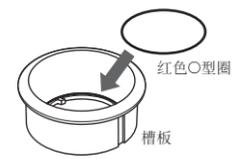
6. 将槽板内的凸片与外壳上的键槽对齐, 将槽板装回到原来的位置。
